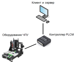
Рис. 3 Вариант развертывания системы на одной ЭВМ
